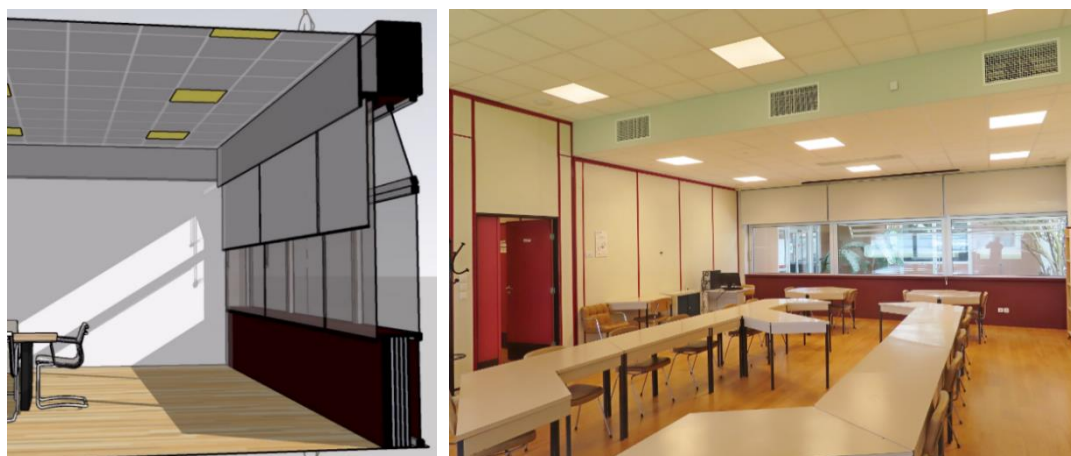
Fig. 3. Estratégias de isolamento térmico e acústico do teto falso e de iluminação eficiente e climatização.
